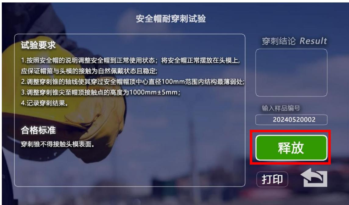
(2) 弹出“释放确认”窗口与提示音，需操作者对试验周边环境进行确认，确保安全后再点击“释放”按钮。
