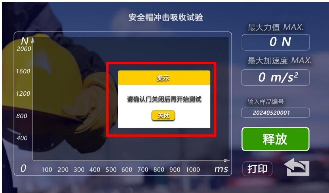
(3) 试验开始进入倒计时与提示音，计时完成即刻释放落锤；
