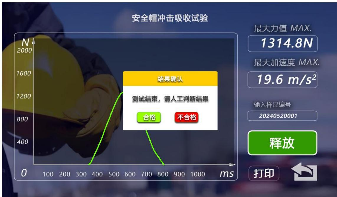
点击“打印”按钮，结果将通过热敏打印机输出，
