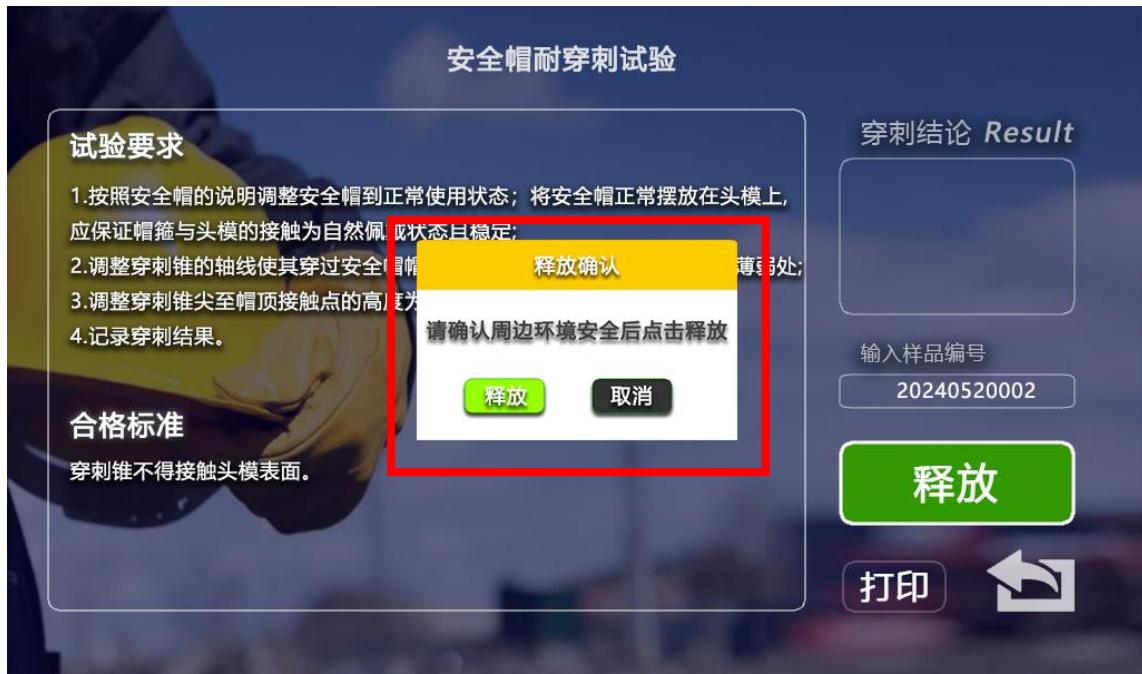
**注意：**点击“释放”按钮后，若弹出“提示”窗口与提示音，请按照提示内容进行确认，如：以下门开启的提示，请确认门正常关闭后再开始测试。
