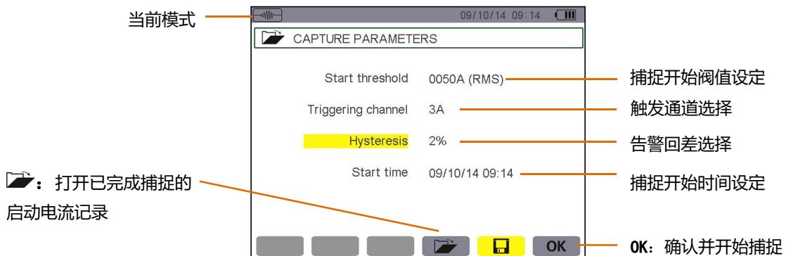
图 6-7 设置启动电流的捕捉排程
