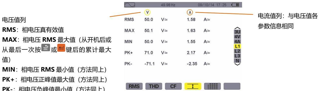
图 8-15 L1 下 Max.-Min. 显示屏幕
