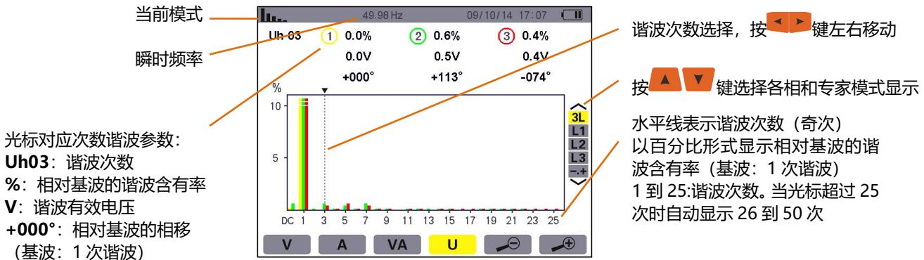
图 7-8 线电压谐波 3L 显示
