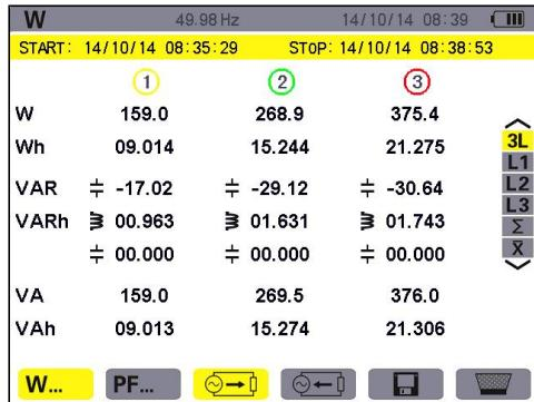
图 11-3 三相(3L)消耗电能的屏幕显示
