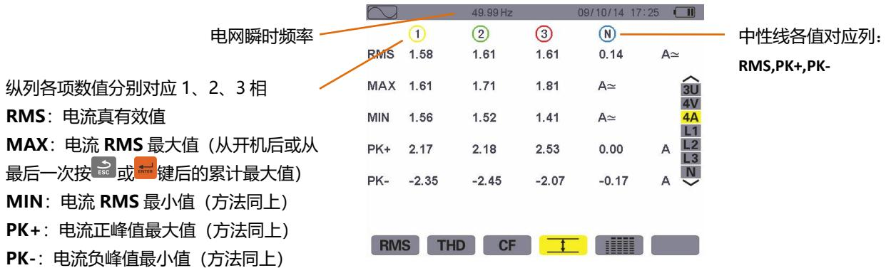
图 8-14 4A 下 Max.-Min. 显示屏幕
