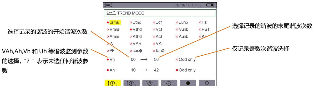
图 10-6 趋势图记录的谐波参数设定
