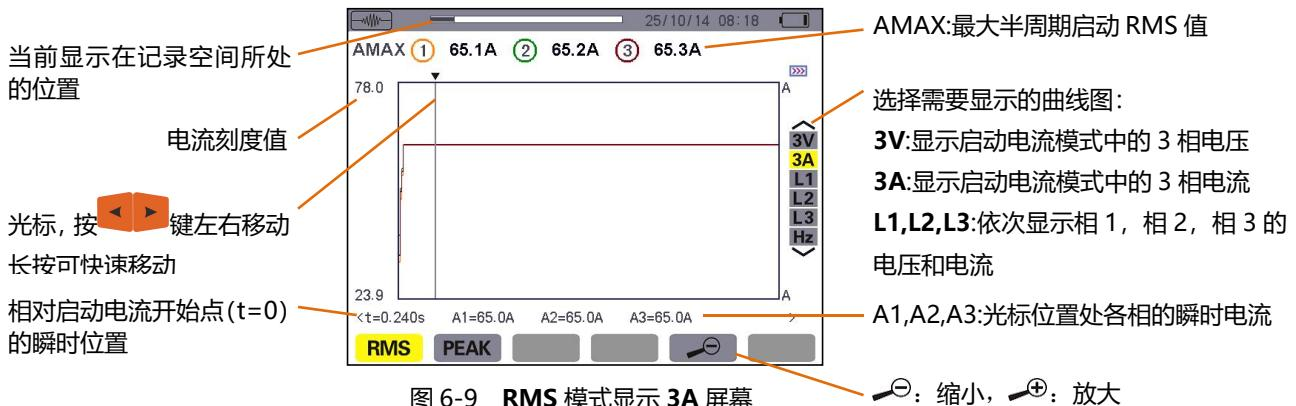
图 6-9 RMS 模式显示 3A 屏幕
