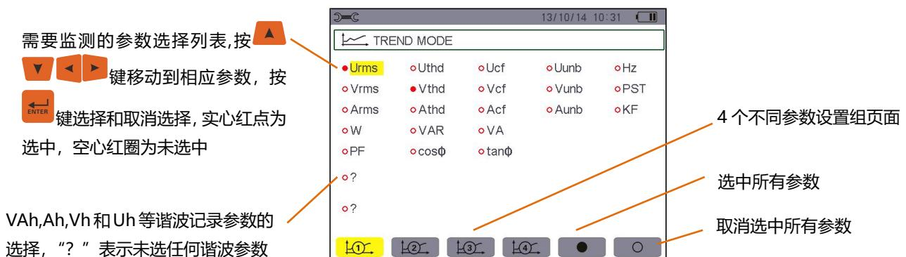
图 10-4 趋势图监测参数设定屏幕
