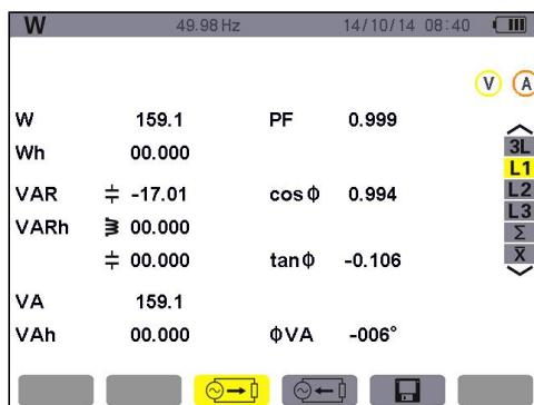
图 11-4 L1 相电能消耗显示屏幕
