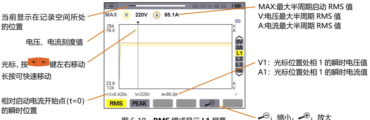
图 6-10 RMS 模式显示 L1 屏幕
