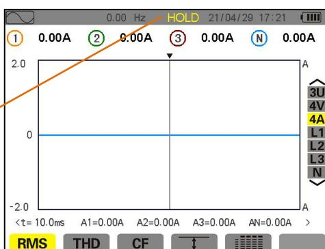
图 16-2 WAVE 模式下的 HOLD 界面
