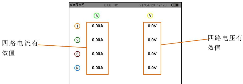
图 14-1 电流电压有效值界面
