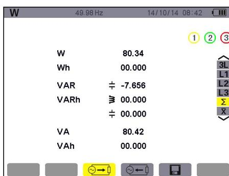
图 11-6 电能消耗三相总和显示屏幕
