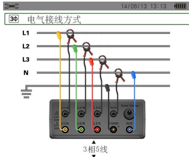
图 5-6 电气连接方式选择
