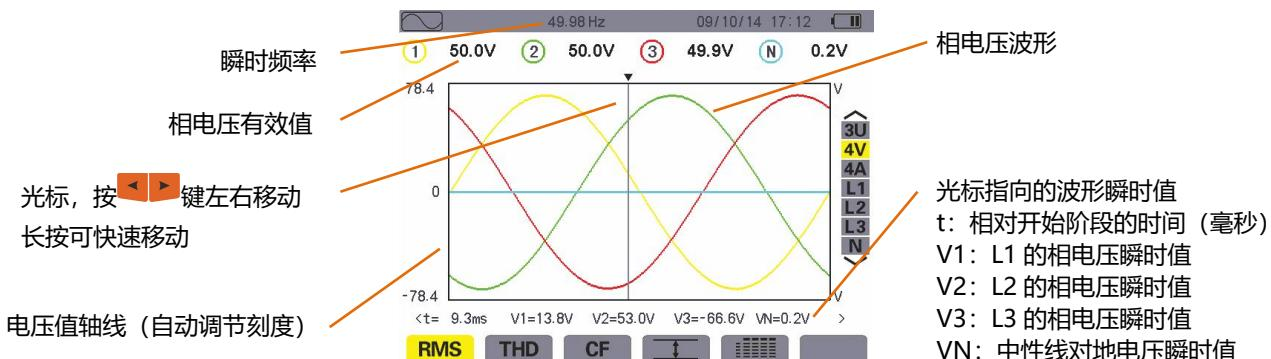
图 8-3 4V 下 RMS 显示屏幕
