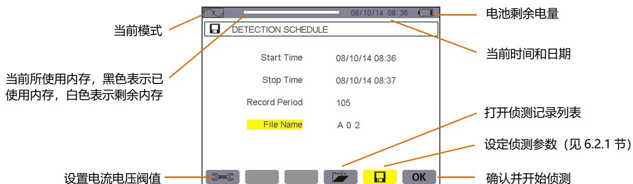
图 6-2 暂态捕捉模式下记录排程
