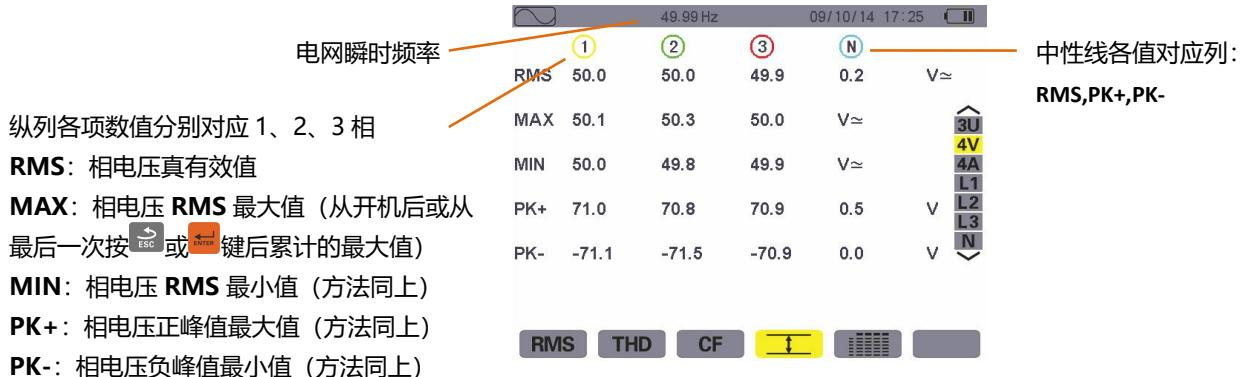
图 8-13 4V 下 Max.-Min. 显示屏幕
