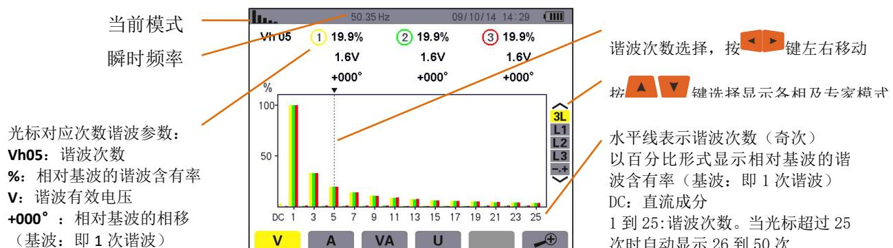
图 7-2 相电压谐波 3L 显示
