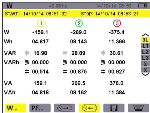
图 11-8 三相(3L)电能产生显示屏幕
