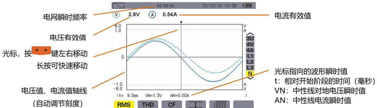
图 8-5 RMS 显示中性线屏幕
