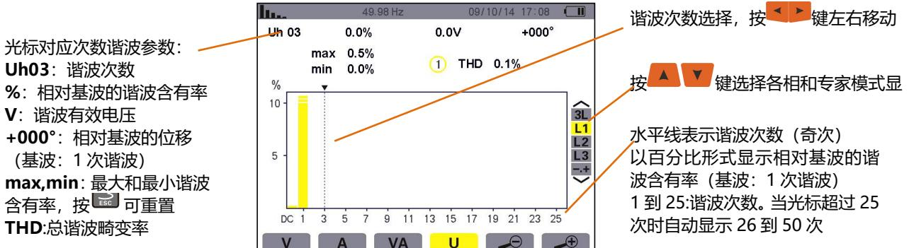
图 7-9 线电压谐波 L1 显示
