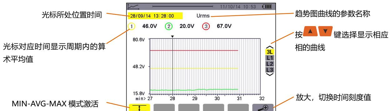
图 10-11 线电压有效值包括最大、最小、平均值
