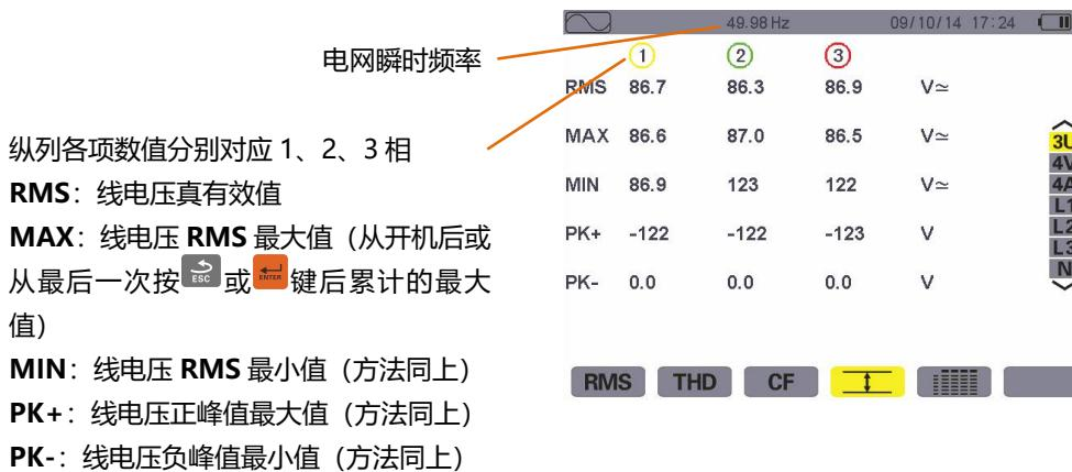
图 8-12 3U 下 Max.-Min. 显示屏幕
