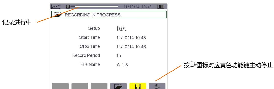
图 10-3 某个趋势图监测的显示屏幕图例
