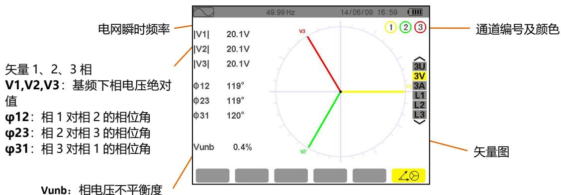
图 13-1 3V 下矢量图示屏幕
