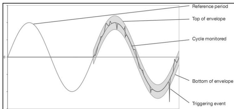
图 18-4 暂态捕捉触发原理图解
