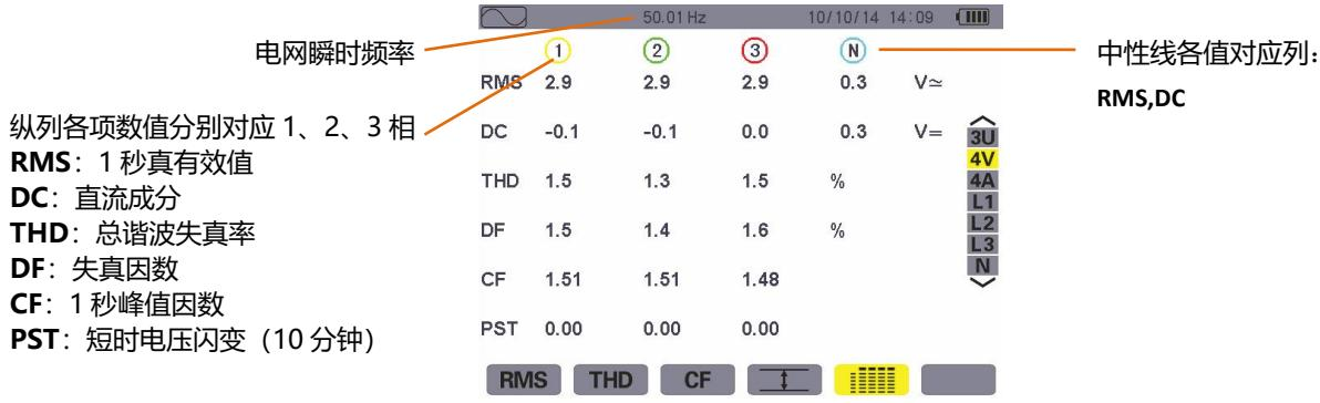
图 8-17 4V 下各值同时显示屏幕
