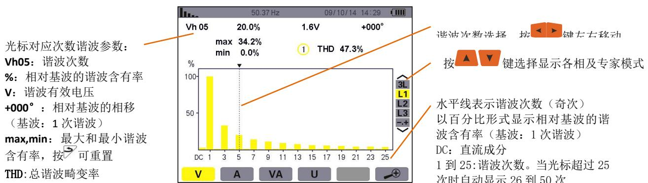
图 7-3 相电压谐波 L1 显示
