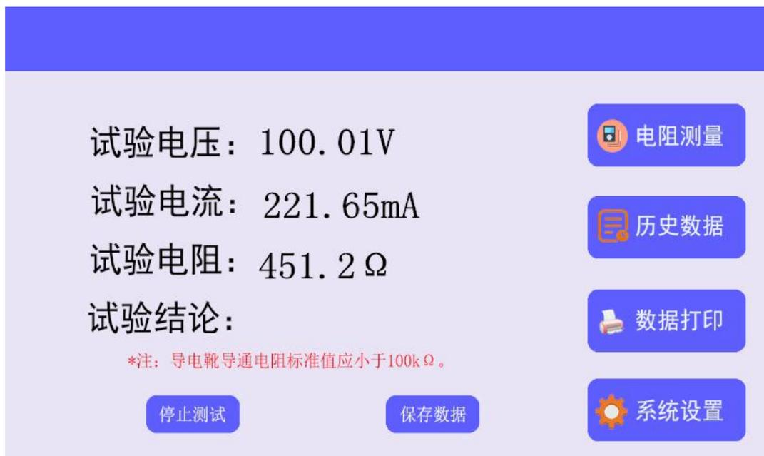
**注意：**操作时，输出带有最高到 **100V** 左右的直流高压，所以人体不得接触相关器件，以免造成触电，测试完成设备会进行放电，界面恢复初始状态，此时可以进行拆装试品。
