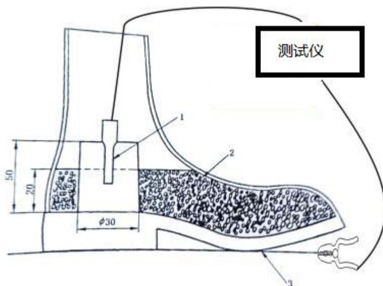
1. 30mm\*50mm 黄铜电极 2.  $\phi$ 4mm304 钢珠 3. 200mm\*300mm 黄铜板电极
