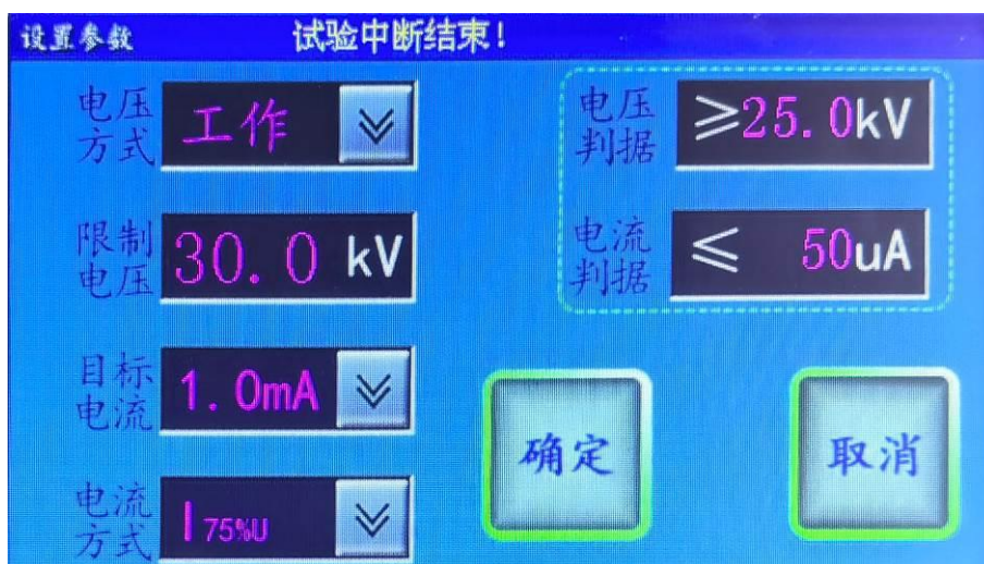
图 8 设置动作试验参数界面
